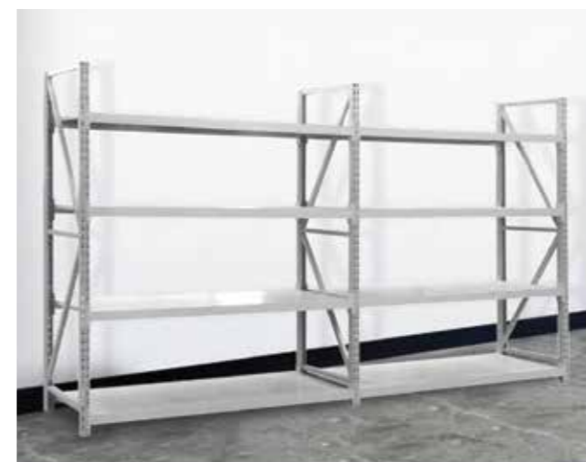
Kích thước: H2000*W1740*D600mm Khung thép: 1.5mm Độ dày mâm: 0,8mm
